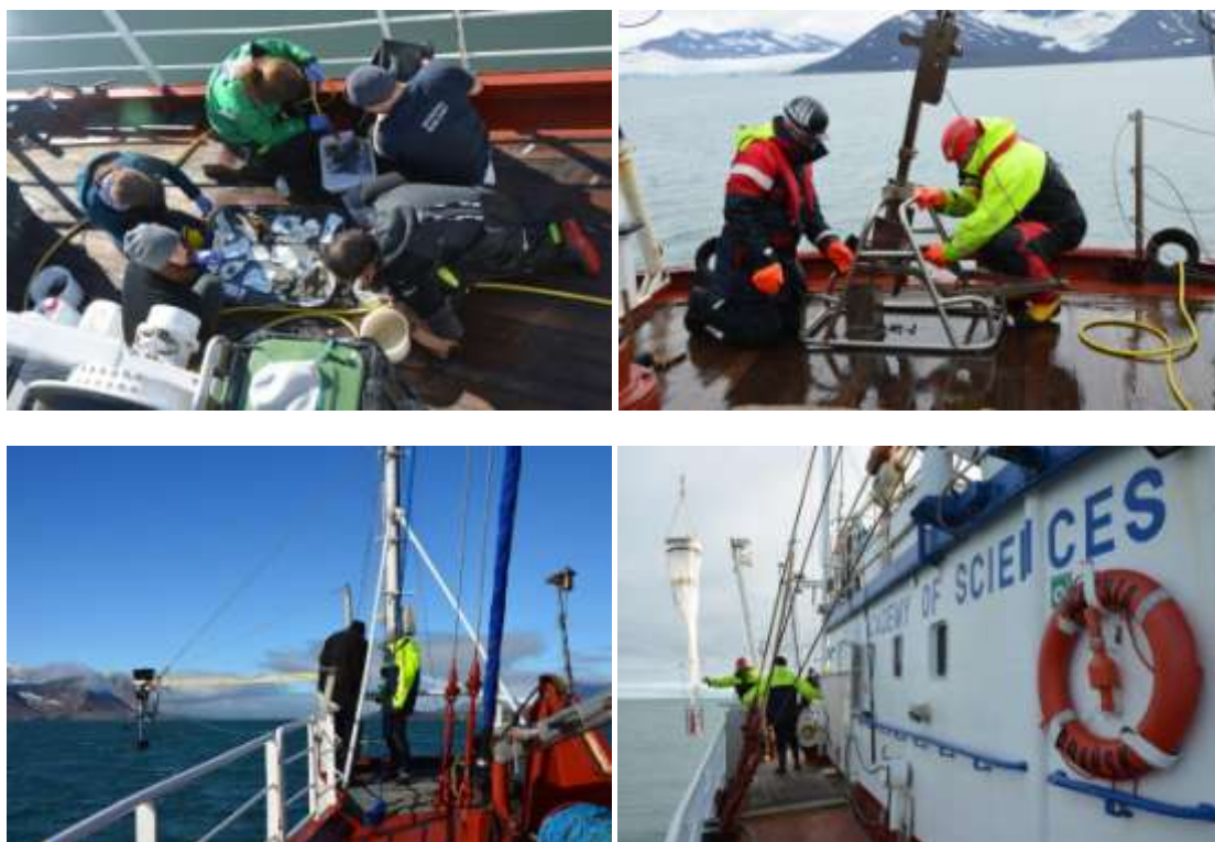
Rys. 6. Sortowanie organizmów bentosowych (a) przygotowywanie czerpacza Box corer (b), pomiary optyczne (c), sieć planktonowa WP-2 (d).
